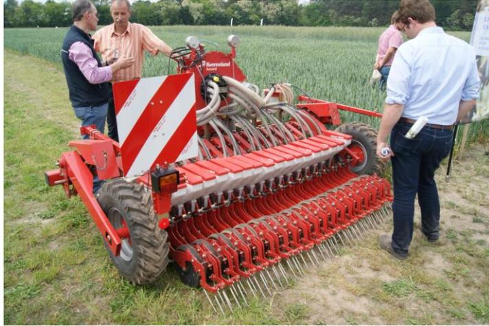
Einzelkornsämaschine mit Geoseed
