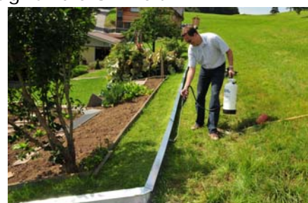
Prof. Ulrichs bei der Applikation von Silikaten in flüssiger Form als selbsterodierende Schicht
