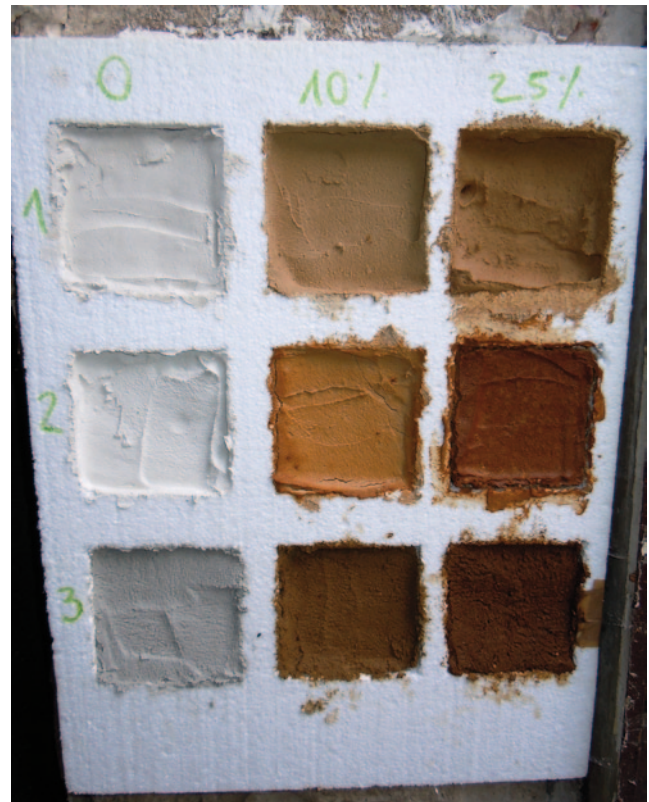
Abb. 2 Putze mit verschiedenen Ligninkonzentrationen (0, 10 und 25 M.%) auf einer Backsteinwand, 1 Gipsputz, 2 Renovier- und Putzmörtel, 3 Sanierputz, 12 Tage nach Aufbringung
