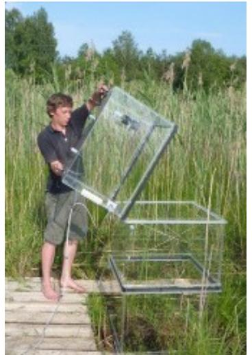
Рис. 29: Измерение парниковых газов на торфяном болоте. Фото: Фонд Михаэля Зуккова
