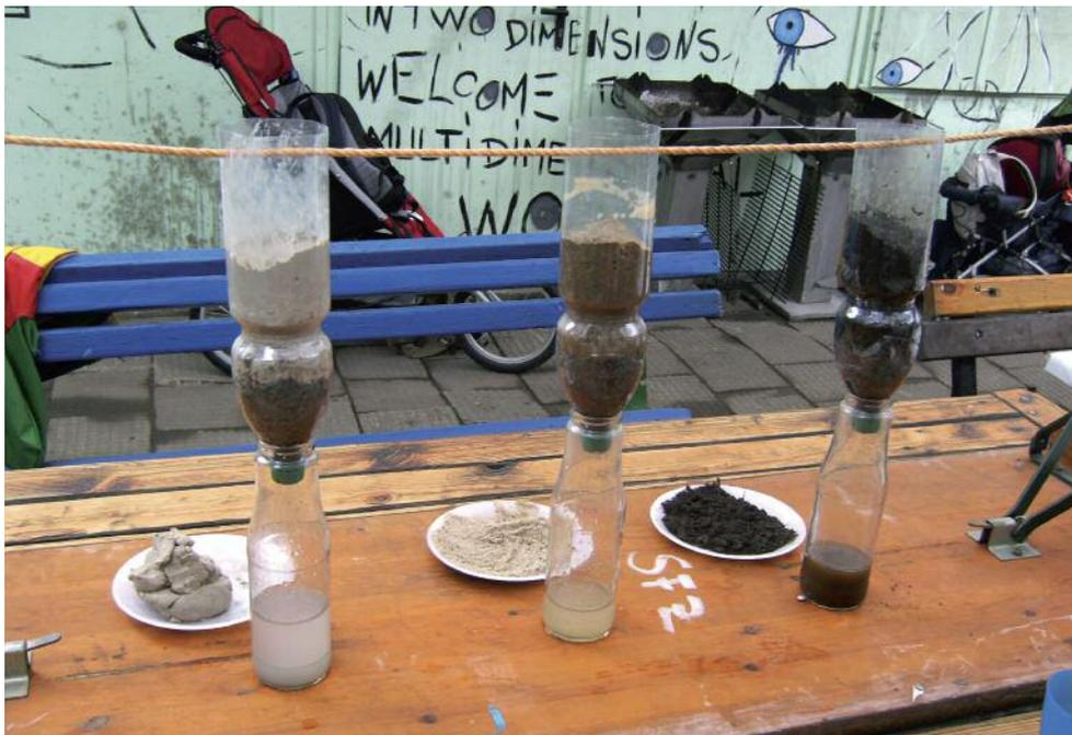
Abbildung 75: Experimentaufbau zu „Wasserhaltevermögen von Substraten“ (Foto: E. Foos)
