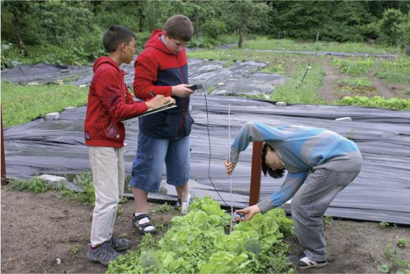
**Abbildung 53:** Messung der Bodentemperatur an der Oberfläche und in 5 cm und 10 cm Tiefe mit zwei Messverfahren (Foto: Schul-Umwelt-Zentrum Mitte)
