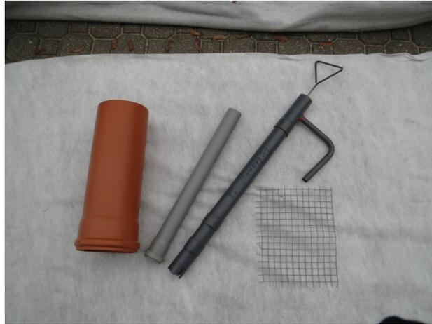
**KG-Rohr DN 150, PE-Rohr DN 50, Pumpe aus PE-Rohr, Drahtgeflecht (13 mm)**
