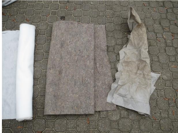
**Bau- und Filtervliese 500 g/m<sup>2</sup>, 1000 g/m<sup>2</sup> und 150 g/m<sup>2</sup>**
