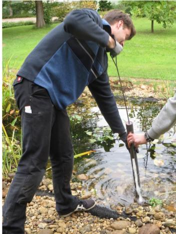
Einfache, selbstgebaute Kolbenpumpe aus PE-Rohren, innenliegendem Kolben, Zugarm und Auslasshahn
