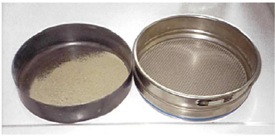
Abb. Prüfsieb nach DIN 4108 mit 2mm Siebdurchmesser
