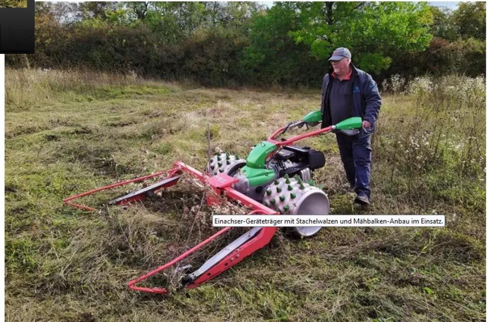
Einachser-Geräteträger mit Stachelwalzen und Mähbalken-Anbau im Einsatz.
