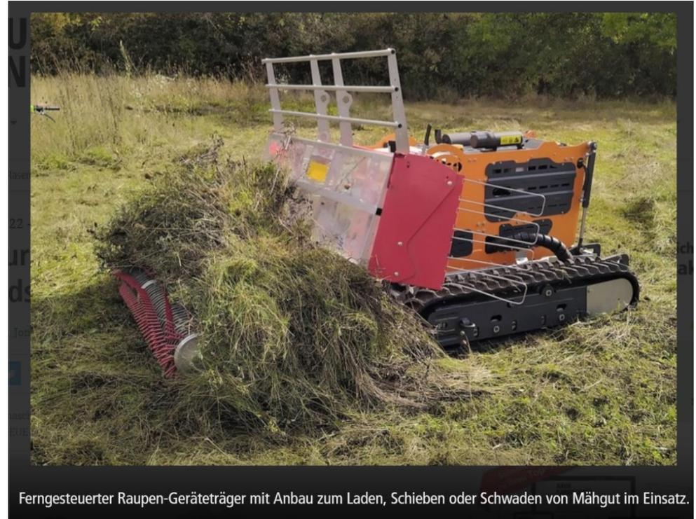
Ferngesteuerter Raupen-Geräteträger mit Anbau zum Laden, Schieben oder Schwaden von Mähgut im Einsatz.
