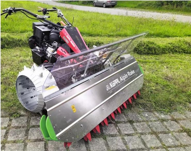
Einachsiger-Geräteträger mit einer Reifen-Stachelwalzen-Kombination und einem Anbau zum Schieben oder Schwaden von Mähgut.
