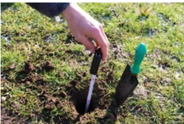
Foto 31: Bodennahme in 10 cm Tiefe
