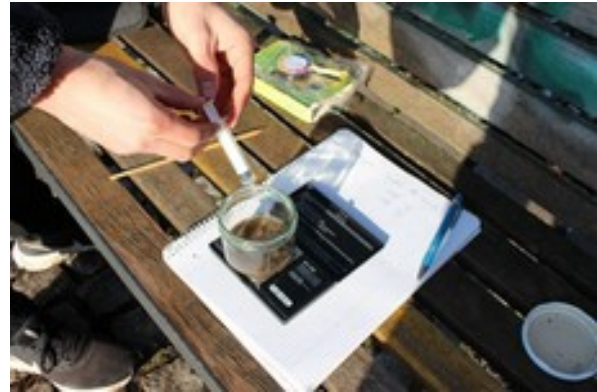
Foto 28: Befeuchtung der Bodenprobe
